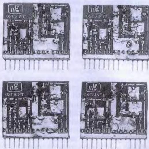
**Fig.1** Per coprire tutta la gamma da 20 MHz a 1.200 MHz occorrono 8 moduli in SMD, che noi vi forniamo già montati e tarati. Come descritto nell'articolo, ogni modulo è in grado di coprire solo una determinata gamma di frequenze, quindi quando li ordinate dovrete indicare quale degli 8 moduli vi interessa ricevere per il vostro VFO.
