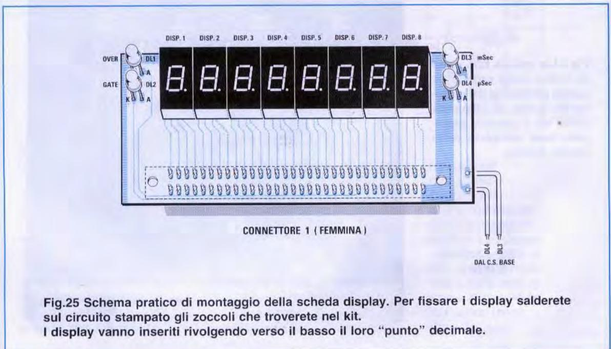
**Fig.25** Schema pratico di montaggio della scheda display. Per fissare i display salderete sul circuito stampato gli zoccoli che troverete nel kit.
