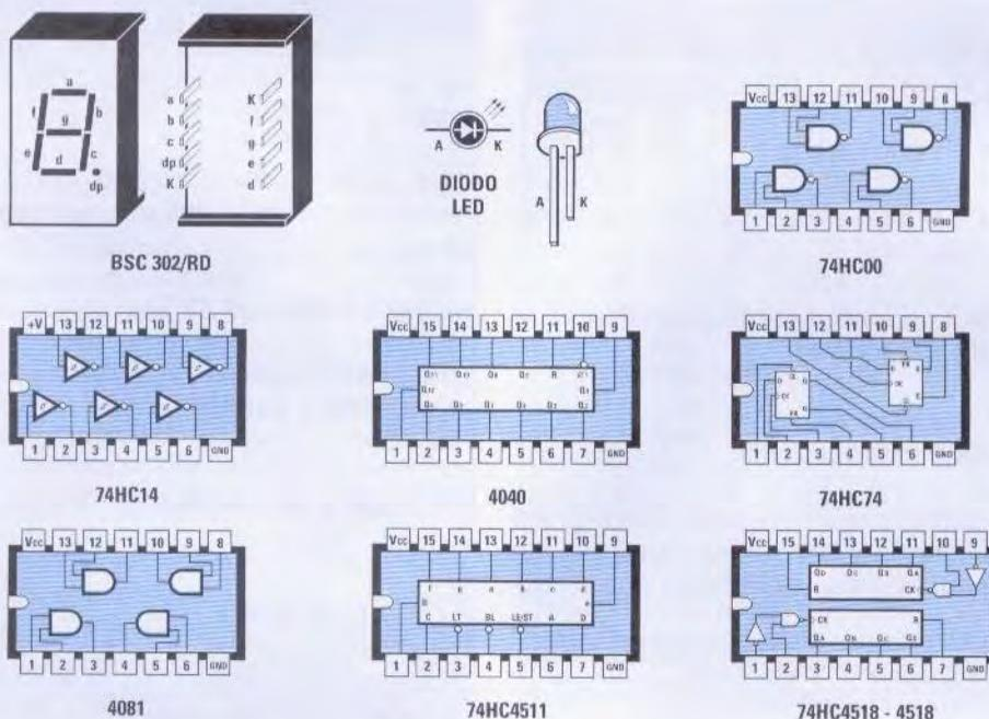
Fig.21 In questo disegno sono riprodotte tutte le connessioni degli integrati utilizzati nel Freqenzimetro viste da sopra. Si noti sul lato sinistro la tacca di riferimento a forma di U. Per il solo display le connessioni sono viste da dietro. Per evitare di inserire un diodo led in senso inverso ricordatevi che il terminale più lungo è l'Anodo.
