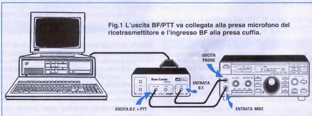
**Fig.1** L'uscita BF/PTT va collegata alla presa microfono del ricetrasmittitore e l'ingresso BF alla presa cuffia.
