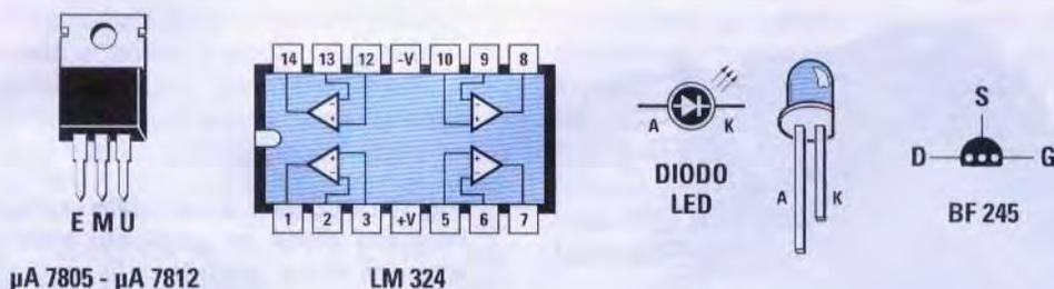
**Fig.28** In questo disegno sono riportate le connessioni dei terminali dei semiconduttori utilizzati in questo progetto. Le connessioni dell'integrato LM.324 sono viste da sopra e quelle del fet BF.245 sono viste da sotto. Il terminale A del diodo led è il più lungo.
