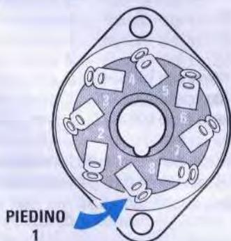
**Fig.16** Nel collegare i fili ai terminali degli zoccoli delle **EL34** dovrete fare molta attenzione a non confondere il piedino 1 con il piedino 8. Perché non possiate sbagliare vi diremo che il terminale posto sulla sinistra della tacca di riferimento a U, è il numero 1 e quello posto a destra è il numero 8.
