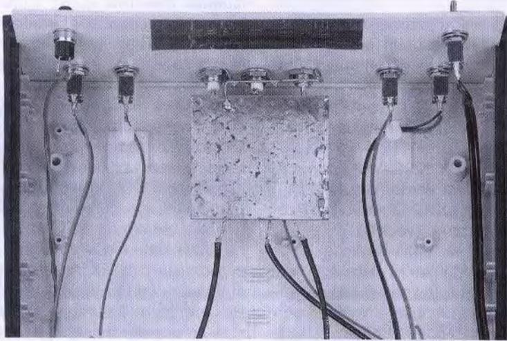
**Fig.23** Le piste d'ingresso dello stadio premontato in SMD andranno direttamente saldate sui terminali dei connettori BNC, non dimenticando di saldare il suo corpo alla massa del circuito stampato. Come si può notare nella foto, il lato schermato del circuito SMD va rivolto verso l'alto.
