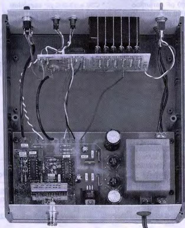
**Fig.16** Sul pannello posteriore va fissato il connettore BNC per poter prelevare la frequenza generata dal VFO. Il BNC che vi forniamo è in grado di lavorare fino ad una frequenza massima di 3 GHz.
