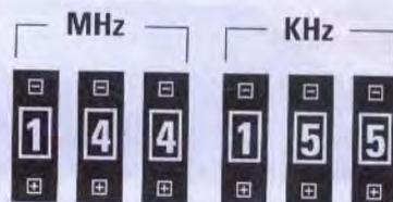
Fig.3 Se la levetta del deviatore **S2** (vedi schema elettrico di fig.17) è posizionata sulla portata **20 - 250 MHz**, le prime tre cifre di sinistra sono i Megahertz e le ultime tre cifre di destra sono i Kiloherzt.
