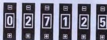
Fig.4 Se volessimo ottenere una frequenza di **27,125 MHz** dovremmo inserire nel VFO il "modulo 1" ed impostare il numero **027.125**.
