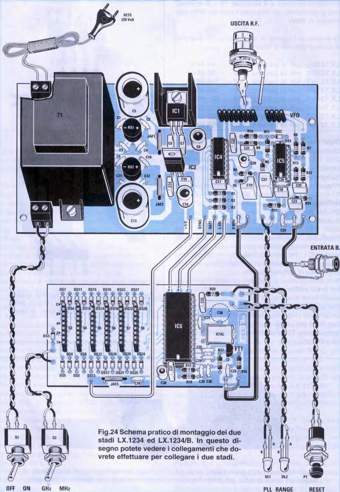
Fig.24 Schema pratico di montaggio dei due stadi LX.1234 ed LX.1234/B. In questo disegno potete vedere i collegamenti che dovrete effettuare per collegare i due stadi.
