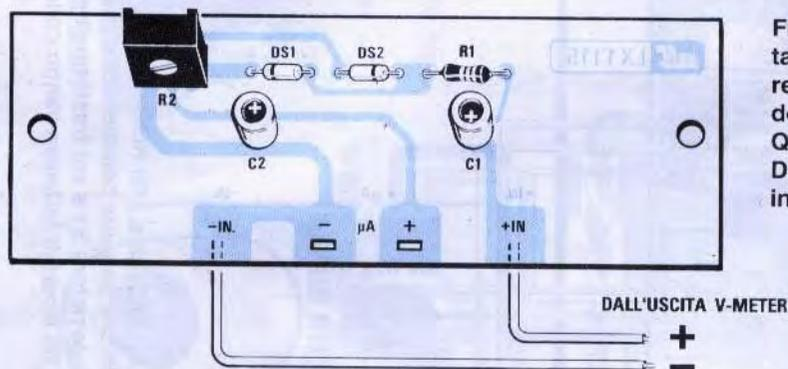
Fig.14 Schema pratico di montaggio. Il trimmer R2 serve per regolare la sensibilità del fondo scala dello strumento. Quando inserirete i due diodi DS1-DS2 fate attenzione a non invertire le due fasce "nere".
