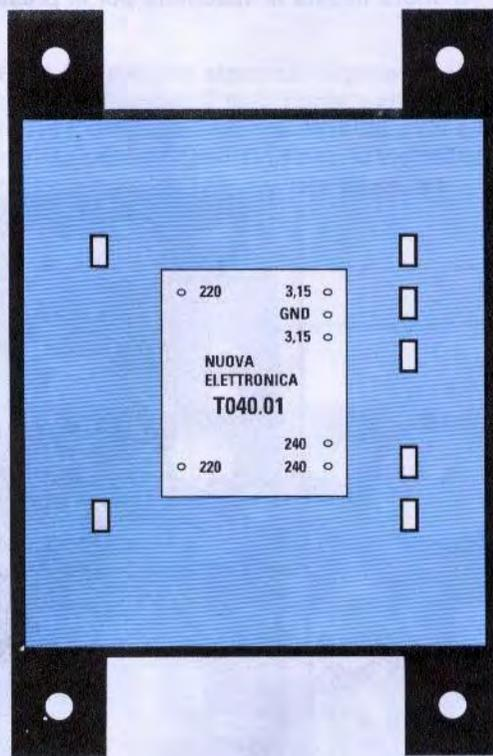
Fig.10 Connessioni dei terminali del trasformatore di alimentazione da noi siglato T040.01. A sinistra troverete i due terminali d'ingresso dei 220 volt. A destra i tre terminali per i Filamenti e quelli dell'alta tensione da 240 Volt.
