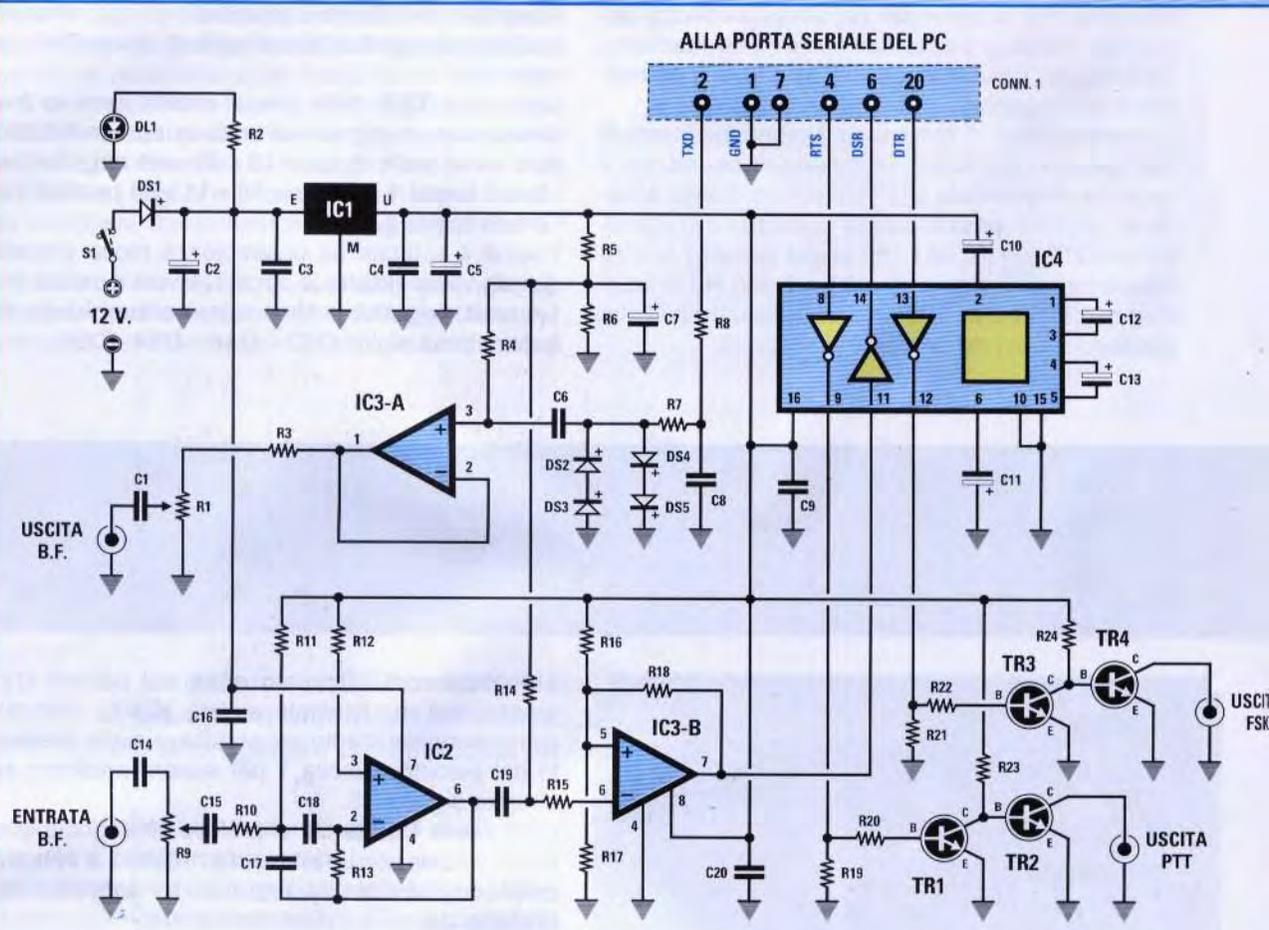
Fig.3 Schema elettrico dell'interfaccia da utilizzare per il programma HamComm.
