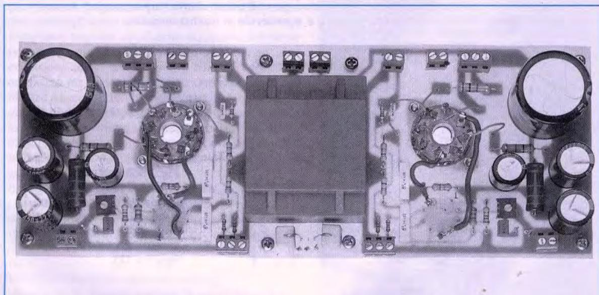
Fig.5 Foto notevolmente ridotta del circuito stampato con sopra già montati tutti i componenti. Gli zoccoli delle valvole vanno fissati dal lato opposto dello stampato (vedi fig.11).
