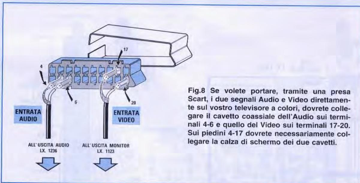
Fig.8 Se volete portare, tramite una presa Scart, i due segnali Audio e Video direttamente sul vostro televisore a colori, dovrete collegare il cavetto coassiale dell'Audio sui terminali 4-6 e quello del Video sui terminali 17-20. Sui piedini 4-17 dovrete necessariamente collegare la calza di schermo dei due cavetti.
