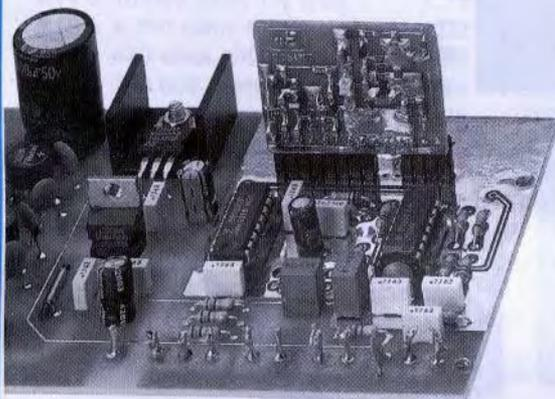
Fig.21 Tutti gli 8 moduli in SMD da noi realizzati per questo VFO erogano una potenza massima di 10 milliwatt, quindi conoscendo il guadagno in dB degli stadi che collegheremo sulla sua uscita potremo conoscere la potenza massima che riusciremo ad ottenere. A pag.62 del nostro HANDBOOK troverete la Tabella dei Guadagni in potenza.
