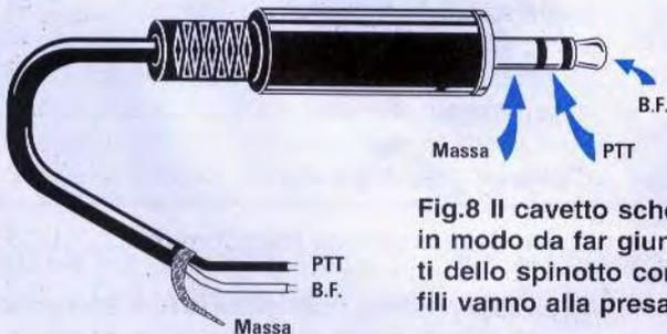
Fig.8 Il cavetto schermato bifilare va collegato alla presa Jack in modo da far giungere i segnali BF, PTT e Massa sui contatti dello spinotto come visibile in figura. Le estremità di questi fili vanno alla presa microfono del ricetrasmittitore.
