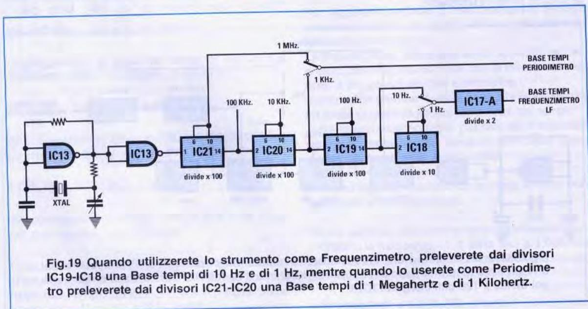
Fig.19 Quando utilizzerete lo strumento come Frequenzimetro, preleverete dai divisori **IC19-IC18** una Base tempi di **10 Hz** e di **1 Hz**, mentre quando lo userete come Periodimetro preleverete dai divisori **IC21-IC20** una Base tempi di **1 Megahertz** e di **1 Kilohertz**.
