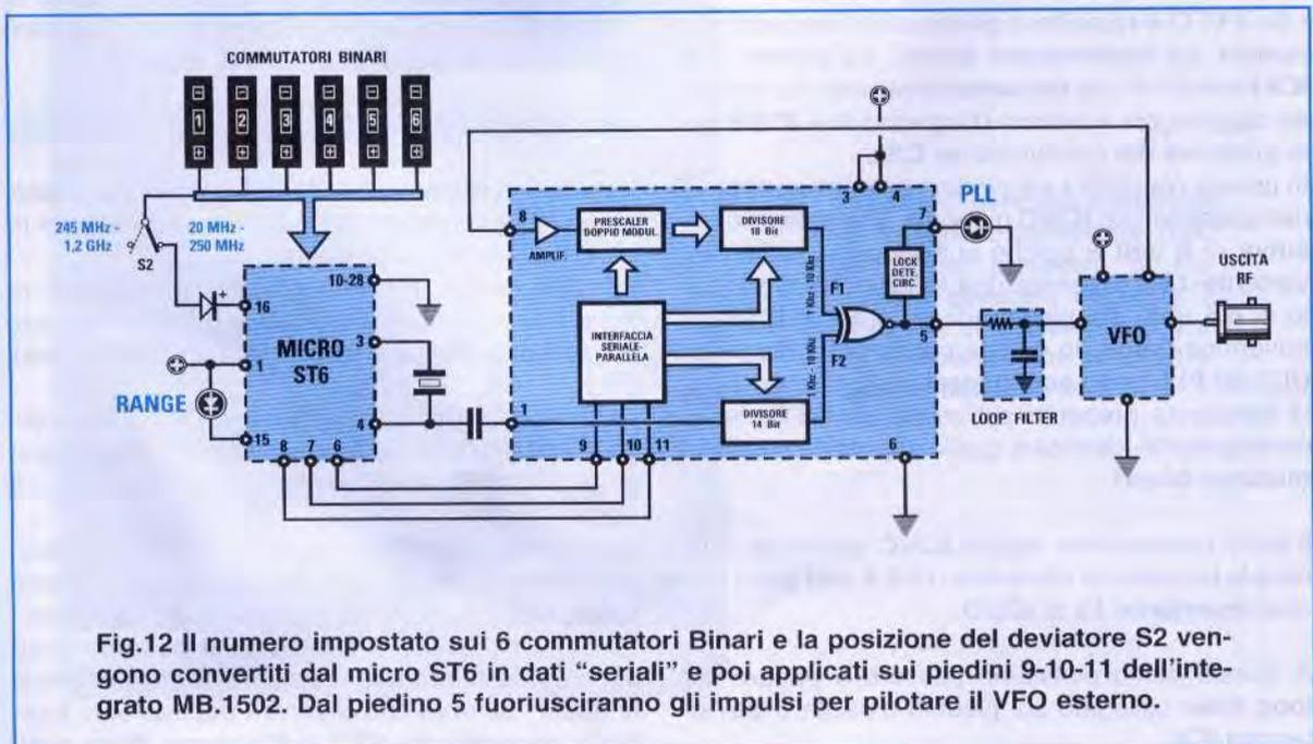
Fig.12 Il numero impostato sui 6 commutatori Binari e la posizione del deviatore S2 vengono convertiti dal micro ST6 in dati "seriali" e poi applicati sui piedini 9-10-11 dell'integrato MB.1502. Dal piedino 5 fuoriusciranno gli impulsi per pilotare il VFO esterno.
