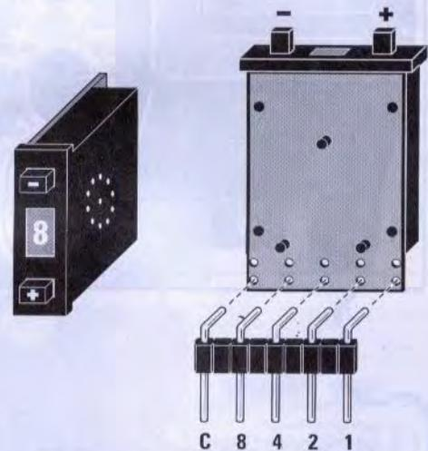
**Fig.26** I 5 terminali rimasti devono essere inseriti sullo stampato di ogni singolo commutatore e poi stagnati sulle piste in rame.
