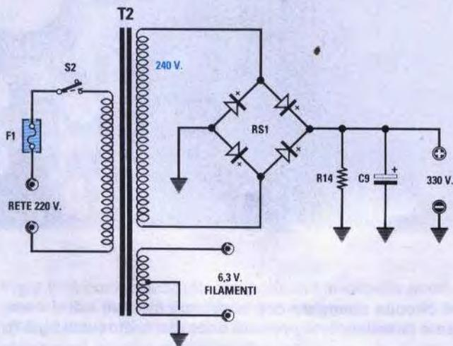
**Fig.3** Schema elettrico dello stadio di alimentazione. Il nostro impianto Stereo necessita di un solo stadio che andrà montato sullo stampato LX.1239 (vedi figg.4 e 12).
