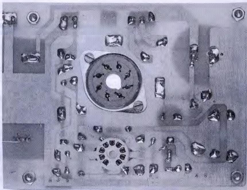
**Fig.11** Gli zoccoli delle valvole vanno fissati dal lato opposto a quello dei componenti. I terminali degli zoccoli delle ECC.82 vanno saldati sullo stampato, mentre quelli delle EL.34 andranno collegati alle piste in rame con degli spezzi di filo (vedi fig.12).
