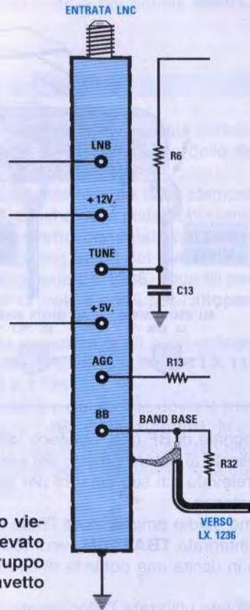
Fig.6 Il segnale Audio viene direttamente prelevato dal piedino BB del gruppo TV tramite un cavetto coassiale.
