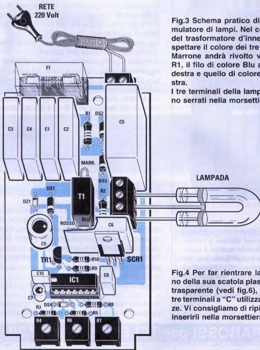
Fig.3 Schema pratico di montaggio del simulatore di lampi. Nel collegare i terminali del trasformatore d'innescò T1 dovrete rispettare il colore dei tre fili. Il filo di colore Marrone andrà rivolto verso la resistenza R1, il filo di colore Blu andrà rivolto verso destra e quello di colore Rosso verso sinistra.
