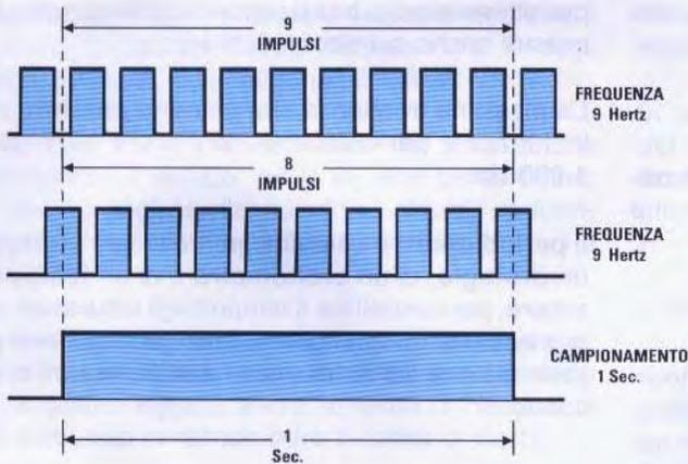
Fig.11 Tutti i frequenzimetri digitali hanno una precisione di +/- 1 digit perchè la frequenza di Clock, applicata sul piedino 2 del commutatore elettronico (vedi fig.4), non si porterà mai a livello logico 1 in sincronismo con la frequenza da misurare. È quindi normale che una frequenza di pochi Hertz, ad esempio 9 Hz, oscilli su valori di 8-9-10 Hz.
