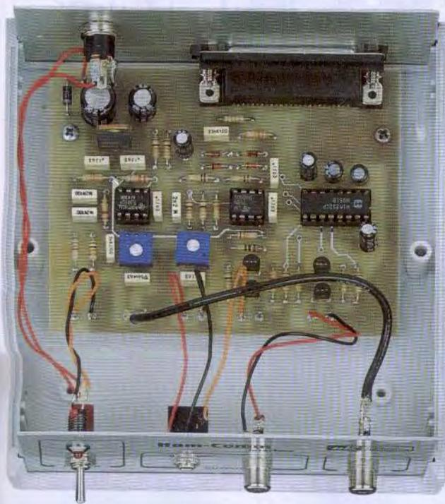
**Fig.2** In questa foto potete vedere come risulta disposta all'interno del mobile la scheda dell'interfaccia descritta nell'articolo. La presa seriale, presente sul pannello posteriore, andrà collegata al computer.
