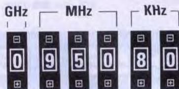
Fig.7 Se la levetta del deviatore **S2** è posizionata sulla portata **245 MHz - 1,2 GHz**, la prima cifra di sinistra sono i Gigahertz, le successive tre cifre sono i Megahertz e le ultime due di destra sono i Kiloherzt.
