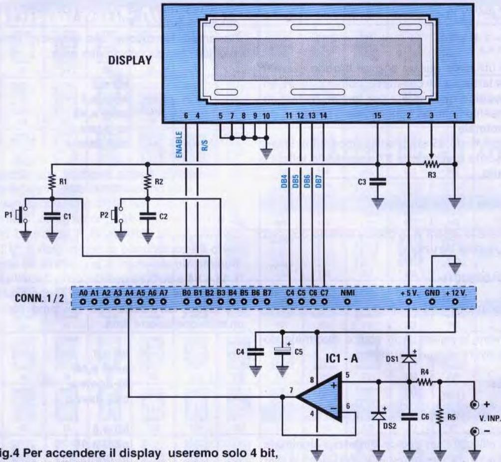
Fig.4 Per accendere il display useremo solo 4 bit, più precisamente DB4-DB5-DB6-DB7, collegati ai piedini C4-C5-C6-C7 del Connettore d'ingresso.
