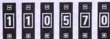
Fig.9 Se volessimo ottenere una frequenza di **1.105,700 MHz** dovremmo inserire nel **VFO** il "modulo 8" ed impostare il numero **1.105.70**.
