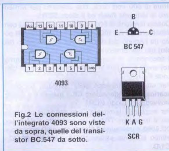
Fig.2 Le connessioni dell'integrato 4093 sono viste da sopra, quelle del transistor BC.547 da sotto.
