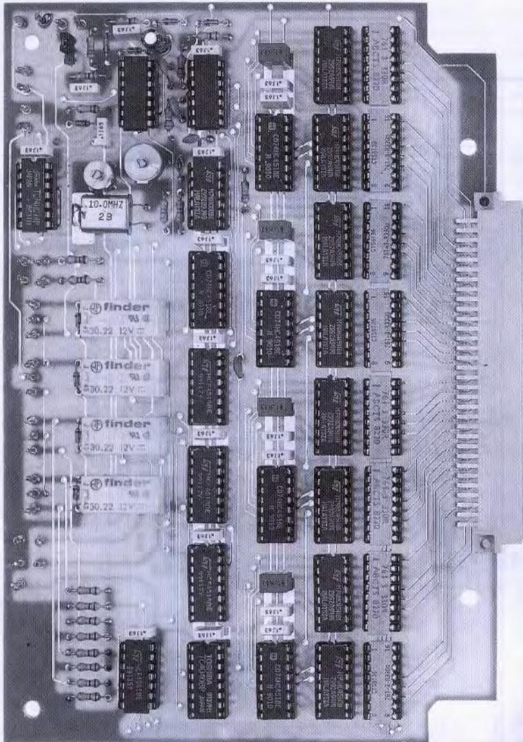
Fig.16 Foto della scheda display. Nella parte posteriore di questo circuito stampato va inserito il connettore femmina che dovrete innestare sul connettore maschio inserito nella scheda base di fig.15. Sulla parte frontale dovrete inserire gli zoccoli per innestare gli otto display di colore verde. In fig.25 è riportato lo schema pratico di montaggio dello stadio display.
