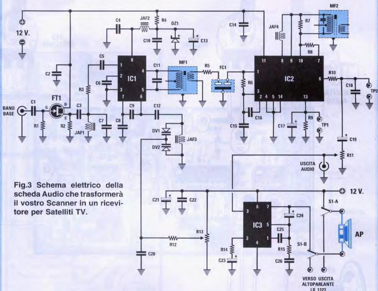
Fig.3 Schema elettrico della scheda Audio che trasformerà il vostro Scanner in un ricevitore per Satelliti TV.
