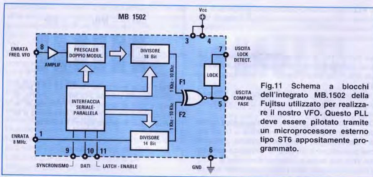
Fig.11 Schema a blocchi dell'integrato MB.1502 della Fujitsu utilizzato per realizzare il nostro VFO. Questo PLL deve essere pilotato tramite un microprocessore esterno tipo ST6 appositamente programmato.
