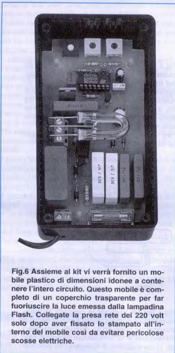
**Fig.6** Assieme al kit vi verrà fornito un mobile plastico di dimensioni idonee a contenere l'intero circuito. Questo mobile è completo di un coperchio trasparente per far fuoriuscire la luce emessa dalla lampadina Flash. Collegare la presa rete dei 220 volt solo dopo aver fissato lo stampato all'interno del mobile così da evitare pericolose scosse elettriche.
