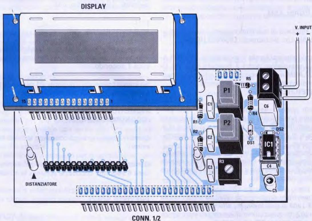
Fig.7 Schema pratico di montaggio della scheda LX.1208. Sul circuito stampato dei display dovrete saldare il connettore maschio a 15 terminali, che dovrete poi innestare nel circuito stampato LX.1208.
