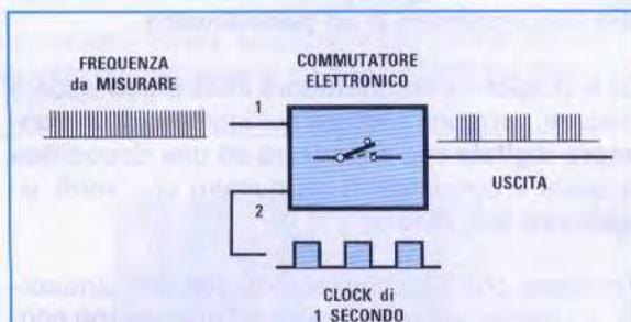
Fig.4 Un frequenzimetro riesce a contare una frequenza tramite un "interruttore elettronico" che lascia passare l'esatto numero di sinusoidi presenti in "1 secondo". Per aprire e chiudere questo interruttore elettronico si usa una frequenza di Clock di 1 Hertz.
