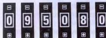
Fig.10 Se volessimo ottenere una frequenza di **950,800 MHz** dovremmo inserire nel **VFO** il "modulo 8" ed impostare il numero **0.950.80**.
