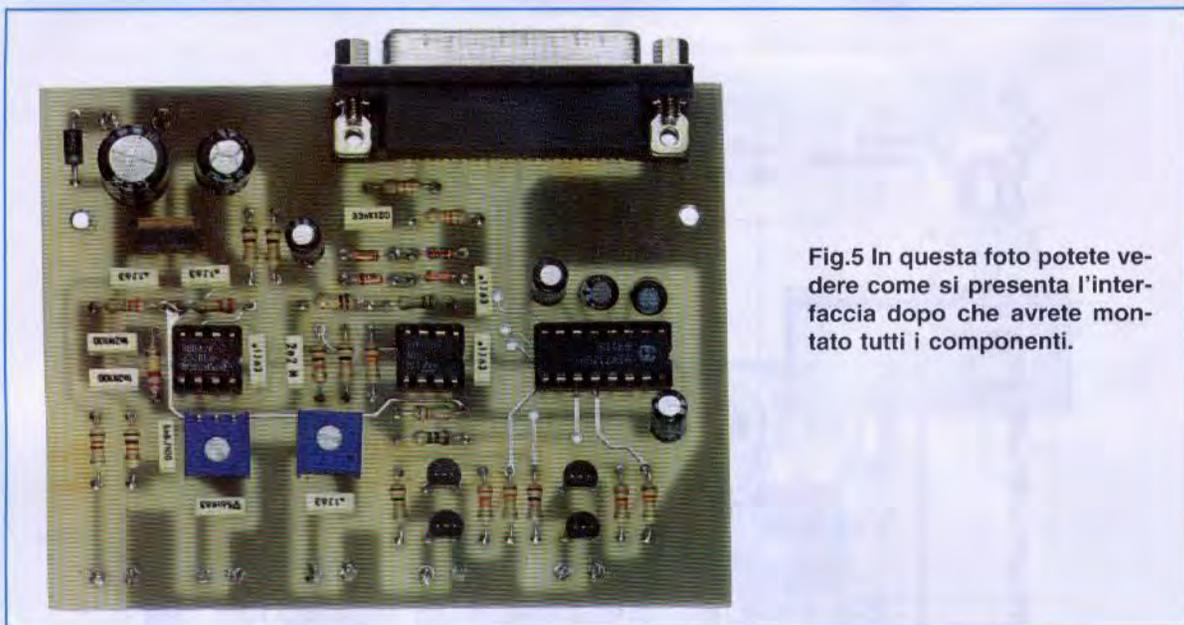
Fig.5 In questa foto potete vedere come si presenta l'interfaccia dopo che avrete montato tutti i componenti.
