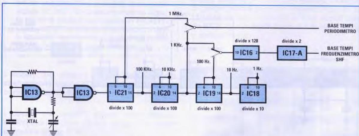
Fig.20 Quando nella funzione Frequenzimetro utilizzerete il Prescaler SHF, preleverete dai divisori IC20-IC19 una Base dei tempi di 1 Kilohertz e di 100 Hz. Questa Base tempi verrà poi divisa **x 128** dall'integrato IC16.
