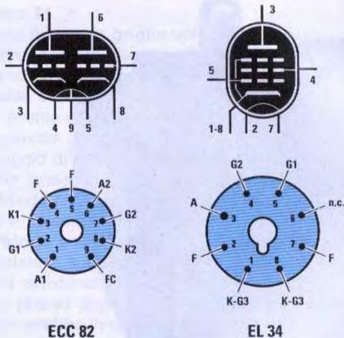
Fig.8 Connessioni dei terminali sugli zoccoli delle due valvole
