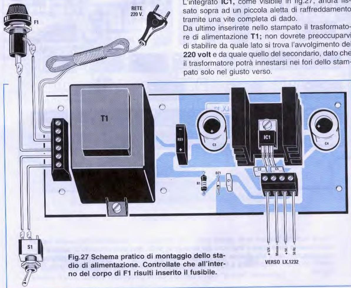
Fig.27 Schema pratico di montaggio dello stadio di alimentazione. Controllate che all'interno del corpo di F1 risulti inserito il fusibile.
