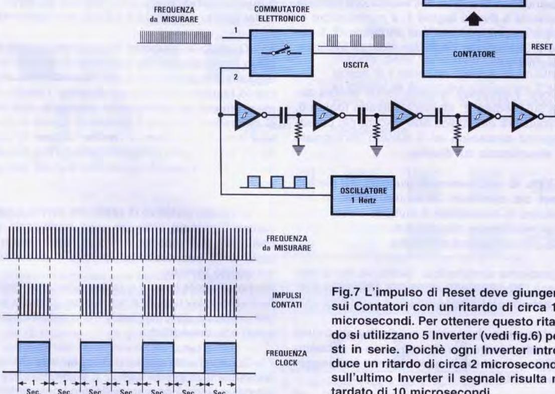
Fig.7 L'impulso di Reset deve giungere sui Contatori con un ritardo di circa 10 microsecondi. Per ottenere questo ritardo si utilizzano 5 Inverter (vedi fig.6) posti in serie. Poiché ogni Inverter introduce un ritardo di circa 2 microsecondi, sull'ultimo Inverter il segnale risulta ritardato di 10 microsecondi.
