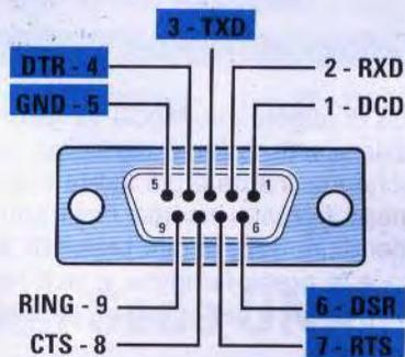
Fig.7 Se la presa d'ingresso seriale del vostro computer è a 9 poli anziché a 25 poli, dovrete collegare:
