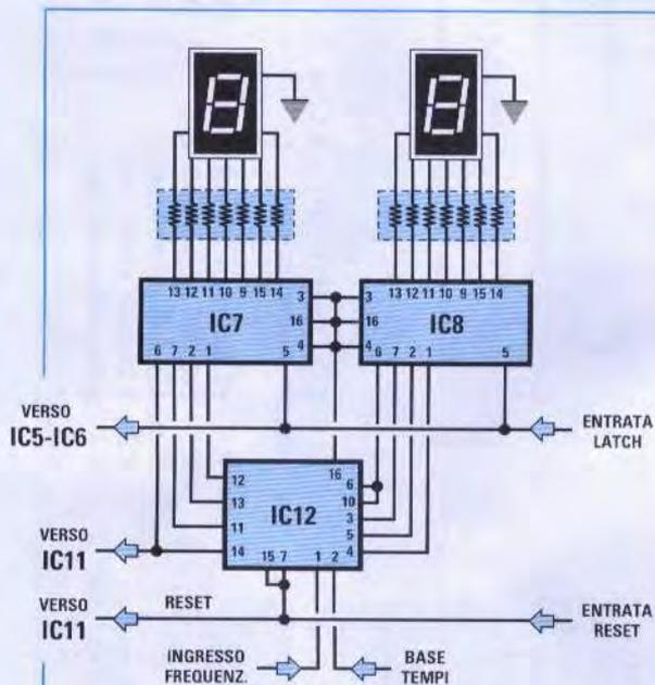
**Fig.18** Come potete vedere nello schema elettrico di fig.14, gli 8 display vengono pilotati da una decodifica completa di memoria siglata HC.4511. Un doppio contatore siglato HC.4518 piloterà una coppia di HC.4511. L'impulso di Latch entrerà nei piedini 5 delle decodifiche/memorie e l'impulso di Reset nei piedini 15-7 dei doppi contatori.
