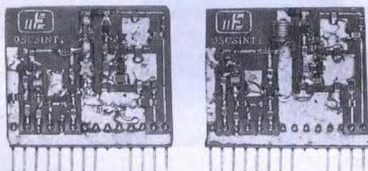
**Fig.30** Come abbiamo già accennato, per poter coprire tutta la gamma di frequenze comprese tra 20 MHz e 1.200 MHz sono necessari 8 moduli in SMD. Se vi interessa solo una o due gamme, potrete richiedere i moduli in grado di coprire le frequenze richieste.
