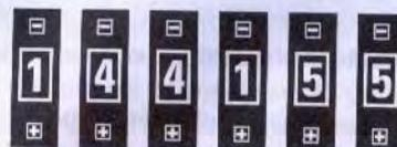
Fig.6 Se volessimo ottenere una frequenza di **144,155 MHz** dovremmo inserire nel VFO il "modulo 4" ed impostare il numero **144.155**.
