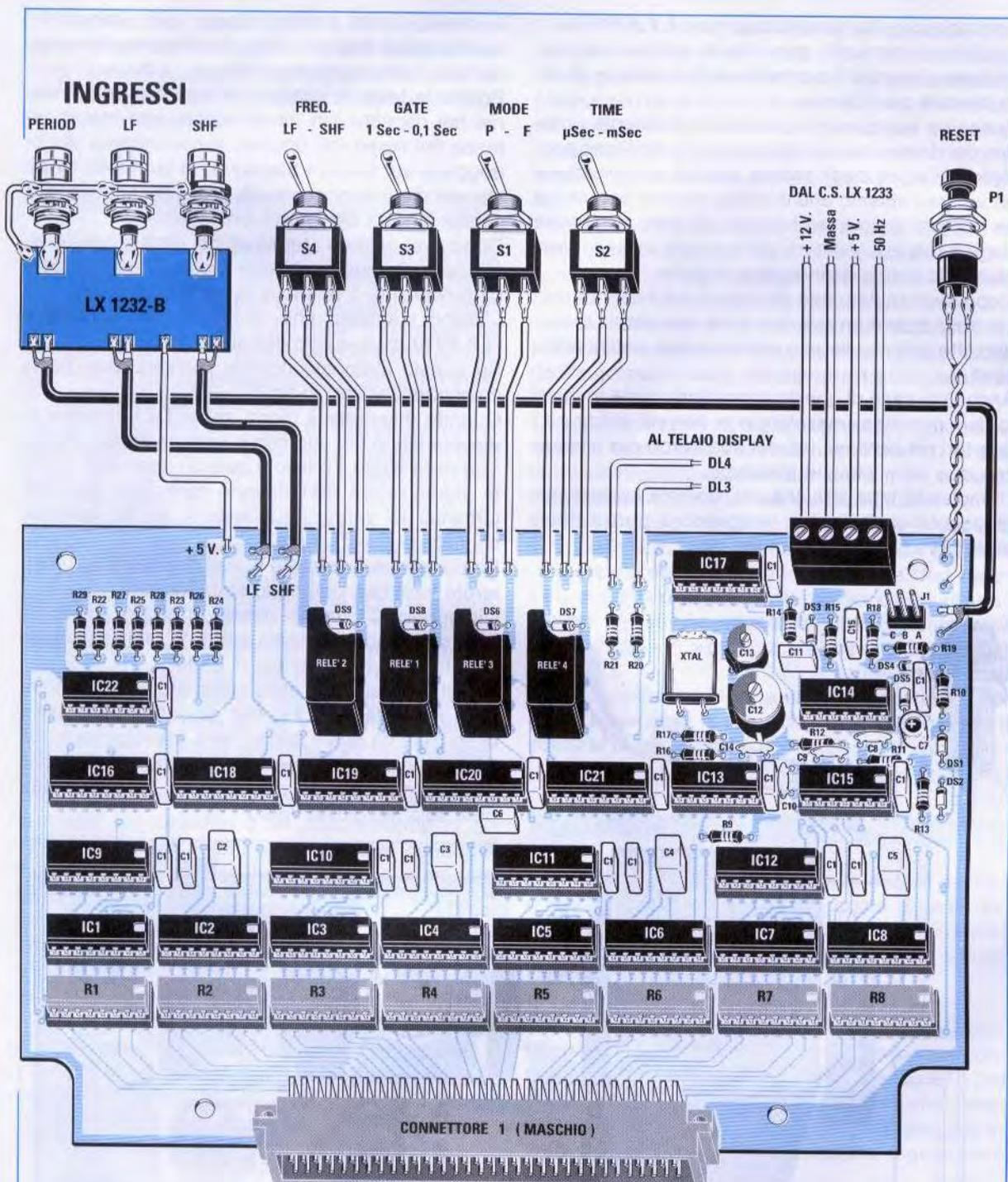
Fig.26 Schema pratico dello stadio base. I tre terminali dei connettori BNC vanno saldati direttamente sulle piste d'ingresso del modulo in SMD, non dimenticando di saldare il loro corpo metallico alla massa del circuito stampato in SMD. Nel piccolo connettore J1, posto sotto alla morsettiera a 4 poli, dovreste innestare il ponticello di cortocircuito (vedi fig.28).
