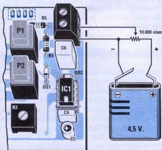
Fig.9 Il programma TESTER.HEX permette di utilizzare questo display alfanumerico in un Voltmetro in grado di misurare un massimo di 5 volt. Per provare questo Voltmetro potrete procurarvi un trimmer da 10.000 ohm ed una pila da 4,5 volt. Ruotando il suo cursore vedrete apparire sui display il valore della tensione.
