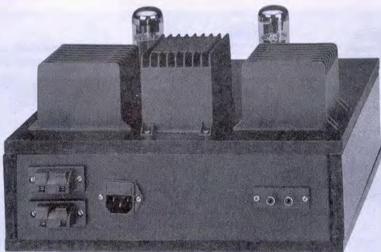
**Fig.6** Sul lato posteriore del mobile dovreste fissare, a sinistra le due prese d'uscita per gli altoparlanti e a destra le due prese RCA d'ingresso. Vicino alle prese per gli altoparlanti andrà fissata la vaschetta per la presa d'ingresso dei 220 volt.
