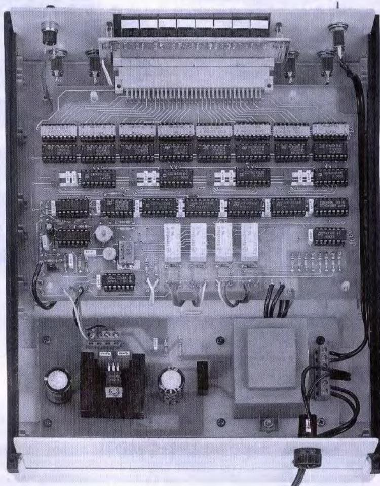
**Fig.24** In questa foto potete notare come vadano disposti all'interno del mobile, lo stadio di alimentazione ed il circuito stampato base completo dello stadio display.
